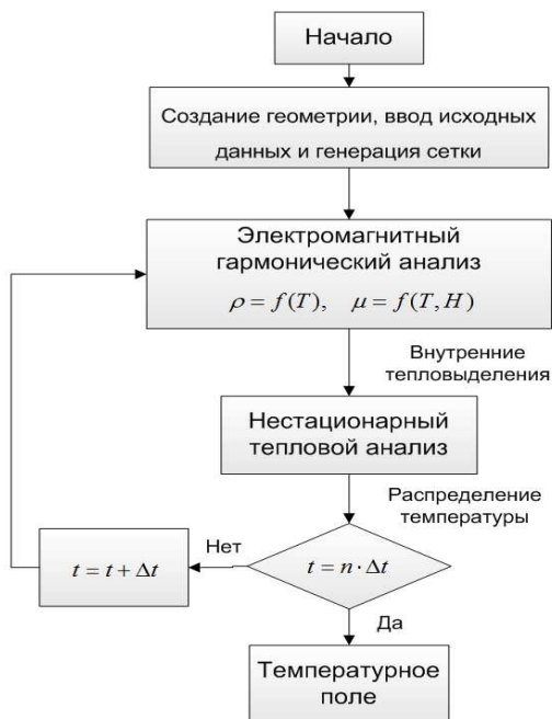
Рис. 6.1. Алгоритм связанного анализа расчёта устройств индукционного нагрева
